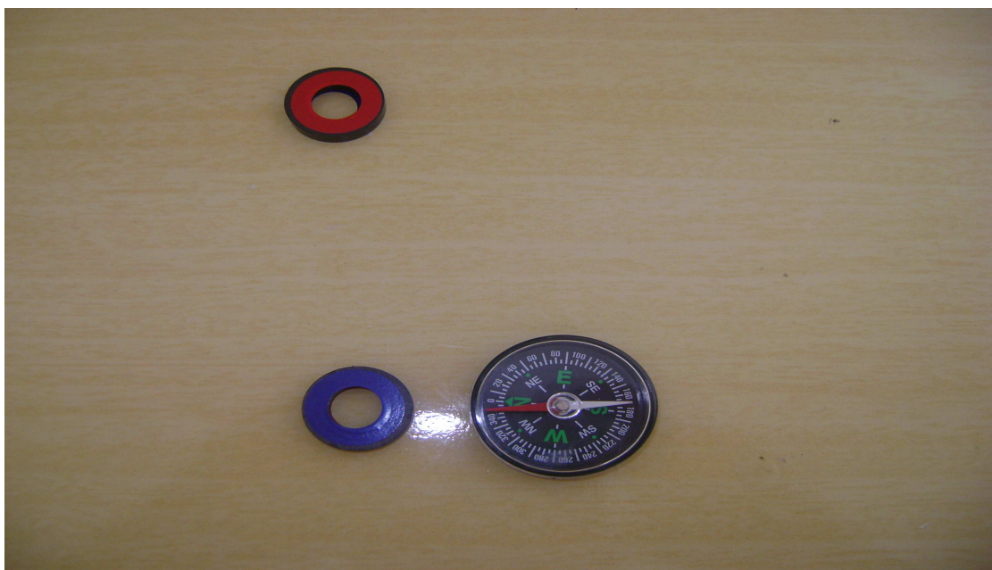
Figura 13: Experimento para descobrir que cor representa os pólos norte e sul dos ímãs
