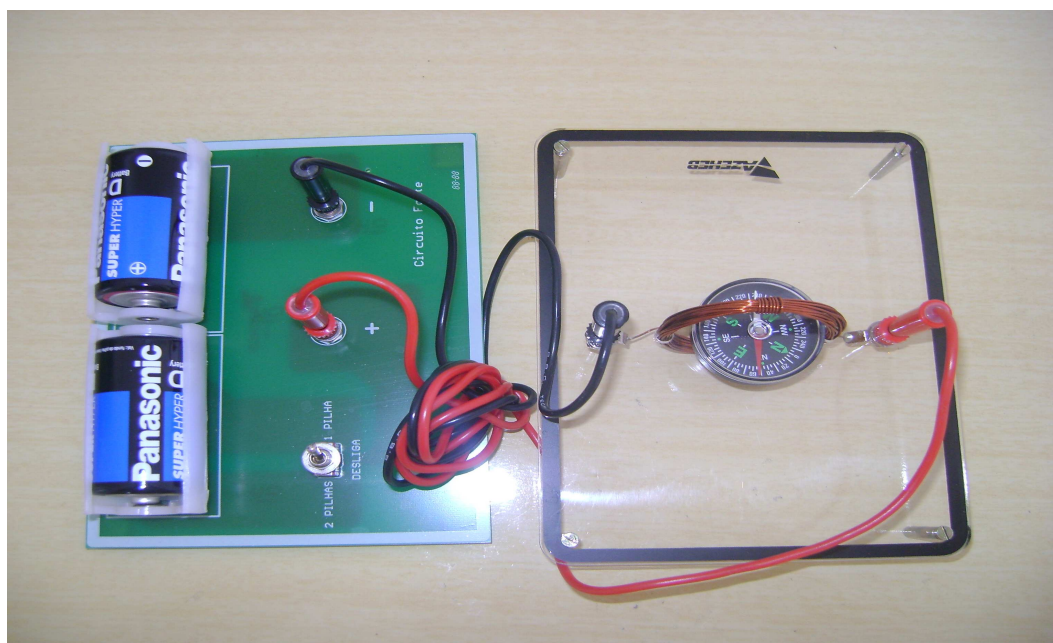
Figura 12: Experimento da Bússola interagindo com o campo gerado pela bobina.
