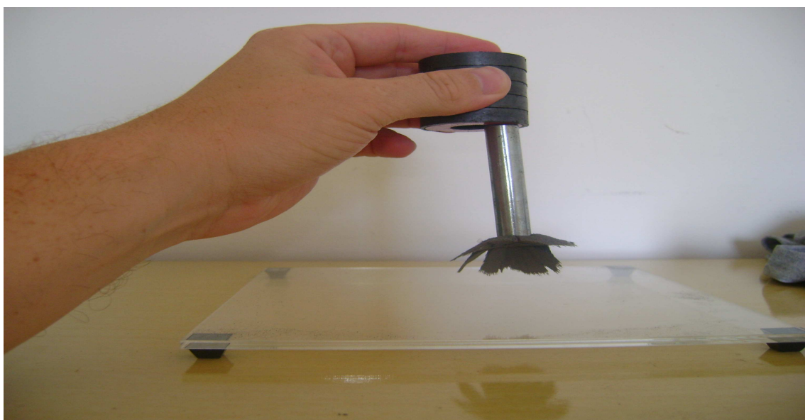
Figura 11: Experimento da limalha de ferro interagindo com o ímã e barra de ferro.
